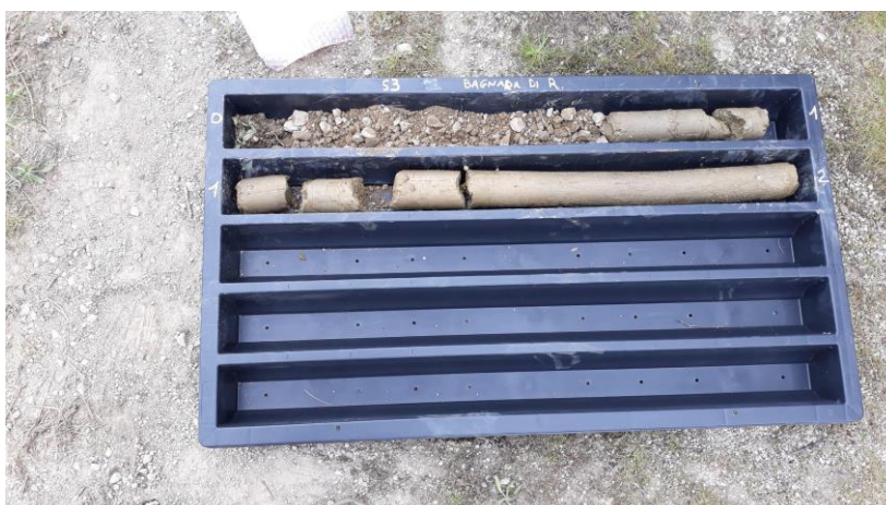
Figura 10 – sondaggio S3, cassa 0-2m
