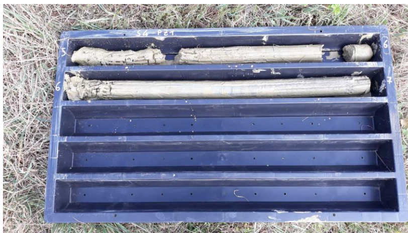
Figura 13 – sondaggio S4-pz1, cassa 5-7m
