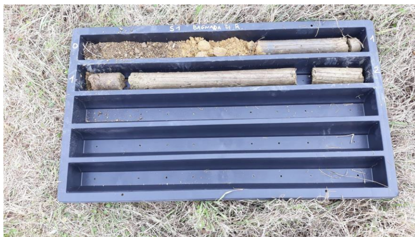
Figura 6 – sondaggio S1, cassa 0-2m
